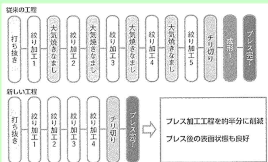
図表4 純チタンのプレス加工の工程比較
